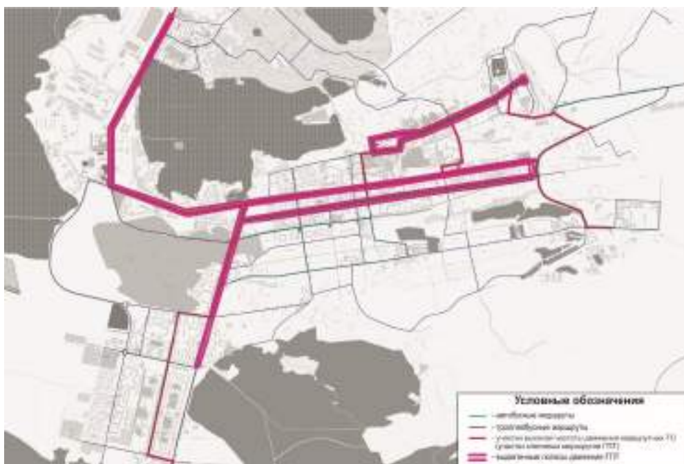
Рисунок 8.2.1.2. Схема новых выделенных полос ГПТ
